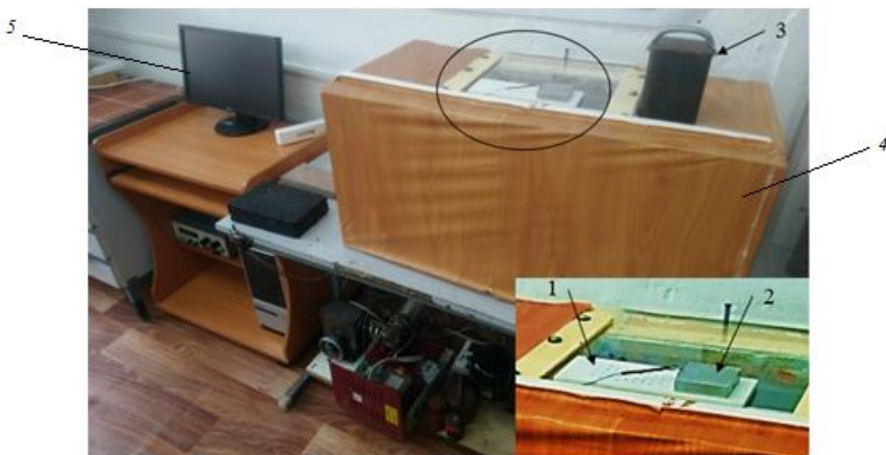
Рисунок 2.1. Стенд для экспериментального определения фрикционных характеристик подошвенных материалов по различным опорным поверхностям:
